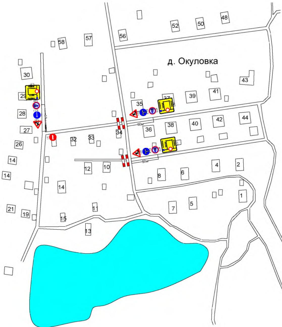
Схема организации дорожного движения и места проведения работ по прокладке газопровода
