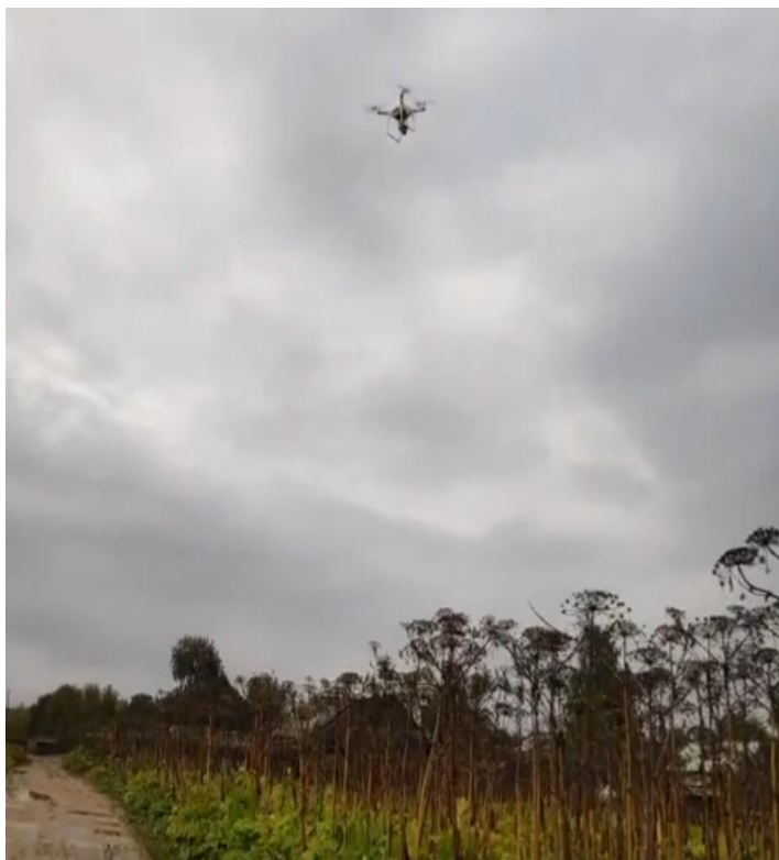
Рисунок 2 - Выполнение аэрофотосъемки беспилотным летательным аппаратом DJI Phantom 4 Advanced
